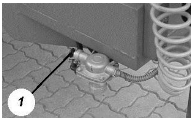
Rys. 17. Zawór hamulcowy opryskiwacza: 1 - przycisk zaworu do odhamowania opryskiwacza
